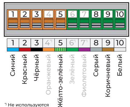
Рис. 6. Клеммная коробка для приводов S08...S20
