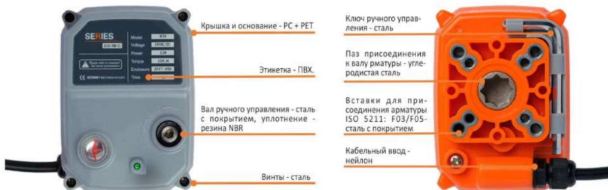
Рис. 7.1. Основные элементы конструкции электроприводов серии Basic B10 и материалы, из которых они изготовлены.
