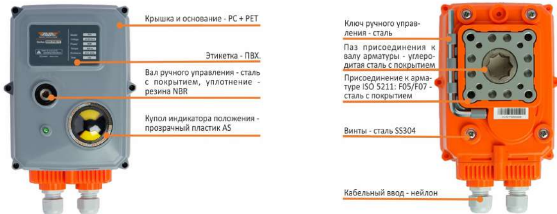
Рис. 7.4. Основные элементы конструкции электроприводов серии Basic B80 и B110 и материалы, из которых они изготовлены.
