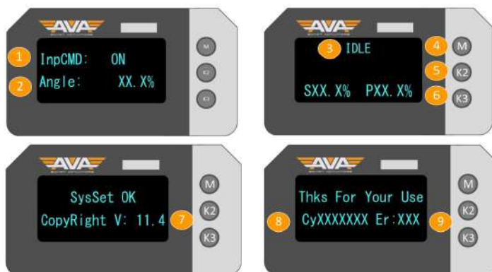
Рис. 10.9. Индикация параметров привода серии Smart: информация, которая отображается на экране в процессе штатной работы электропривода, когда Пользователь не находится в меню.
