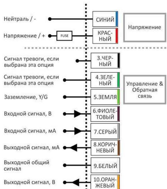
Рис. 10.8. Схема электрического подключения приводов серий Smart S50/S80/S110/S200 и S400
